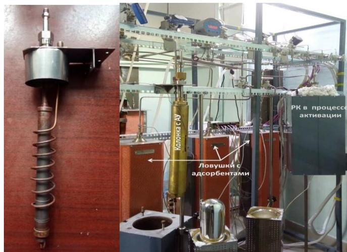
Схема, внешний вид стэнда и реактора Орто-Пара конверсии H<sub>2</sub>
